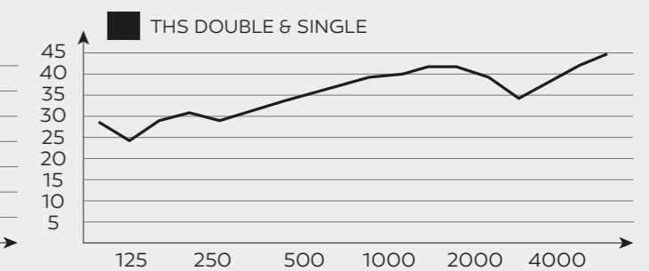
Akustische Abdichtung der Scheibe R [dB] hinsichtlich der Frequenz [Hz]
